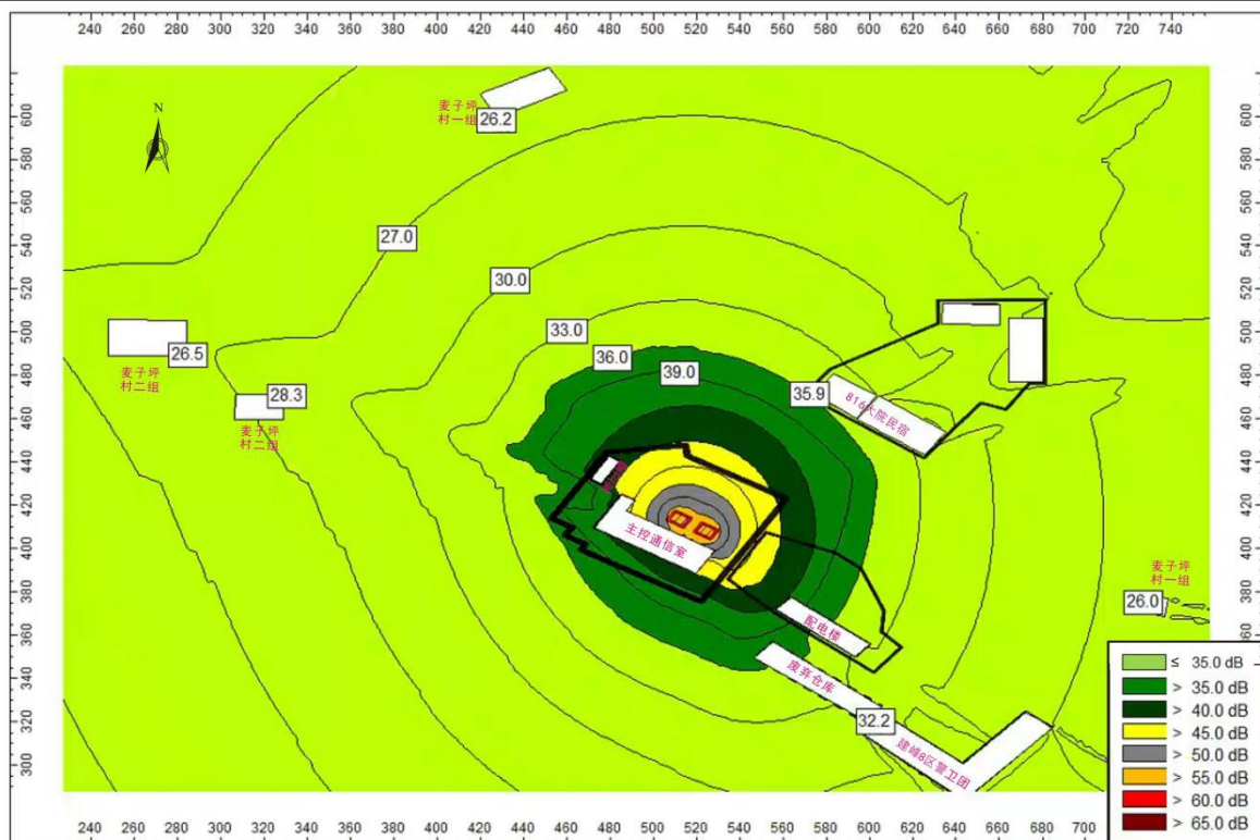
图 4-7 110kV 陈家嘴变电站四侧声环境保护目标噪声贡献值（预测高度 7.5m）
