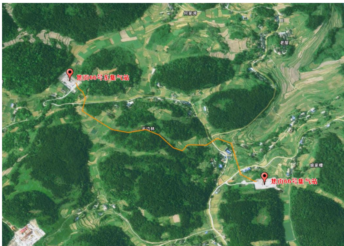
图 2.2-3 焦页 66 号东至焦页 66 号集气支线平面示意图
