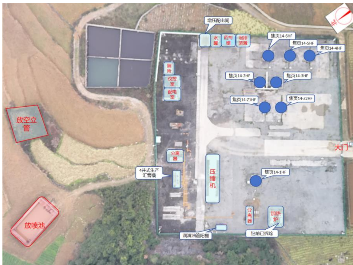
图 2.1-4 焦页 14 号集气站建设现状
