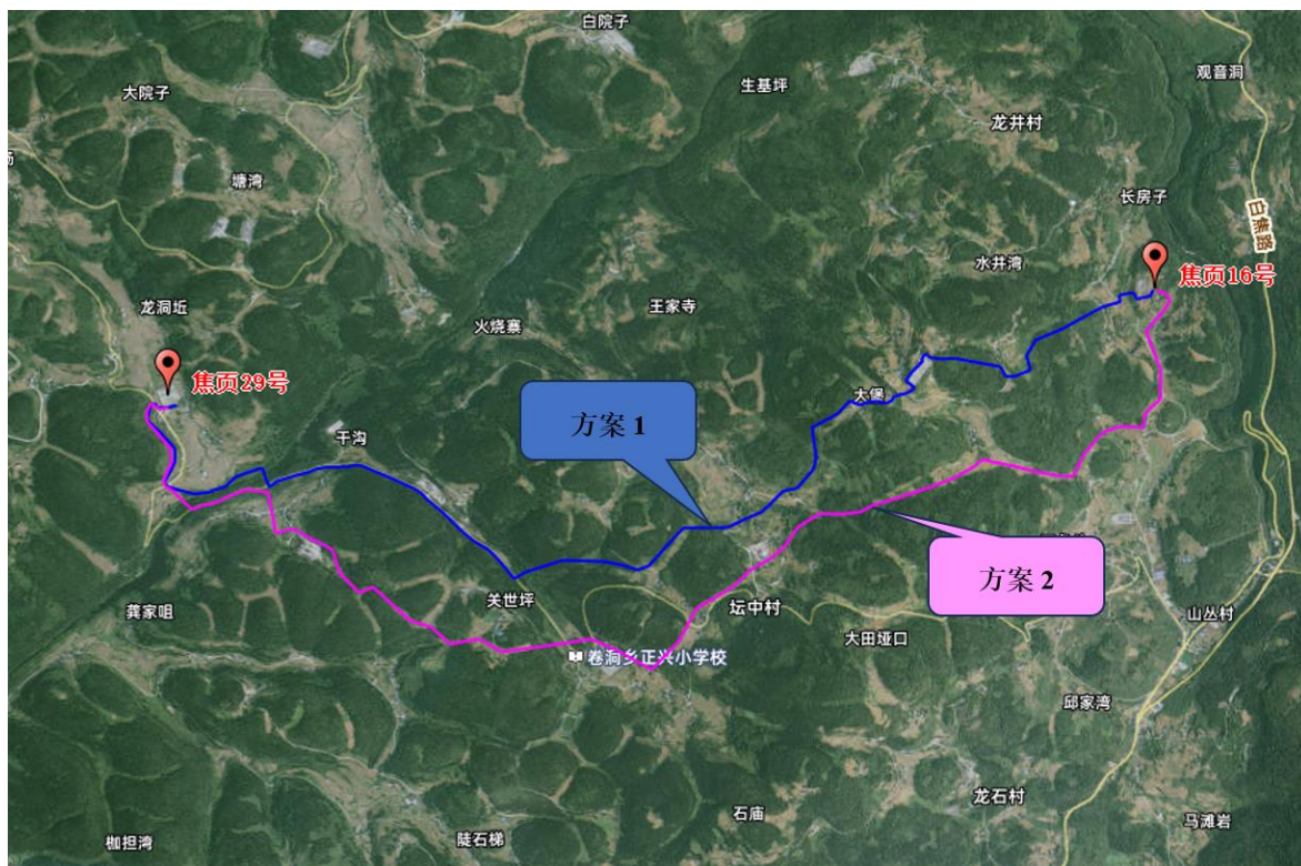
图 1.8-2 焦页 16 号至焦页 29 号平台采出水管线线路比选方案图
