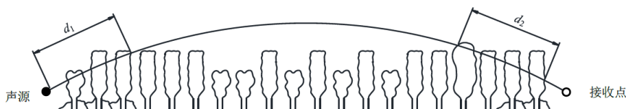
图 4.2-5 通过树和灌木时噪声衰减示意图
